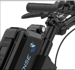
TRAIETTORIA ASSISTITA Maggiore comfort e sicurezza di guida. Il sistema di sterzo autocentrante raddrizza il PAWS dopo il rilascio
