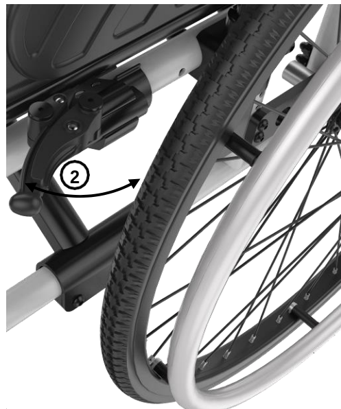
Bremse gelöst (der Rollstuhl kann rollen)
