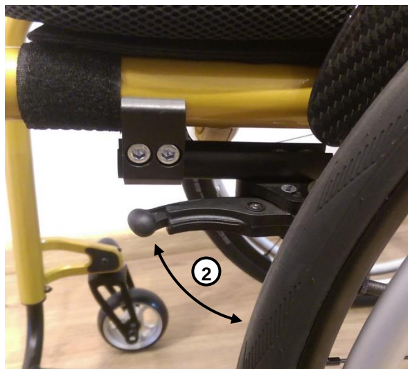
Freno rilasciato (la carrozzina può muoversi)
