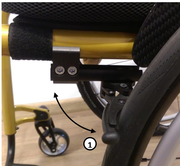
Freno inserito (la carrozzina non si muove)
